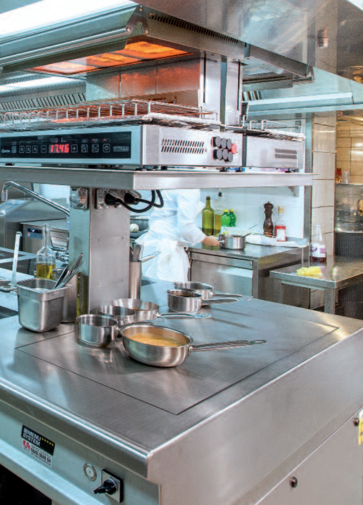
Auf der linken Seite sind Bainmarie, Induktions-Multicooker und Doppel-Oeko-Salamander zu sehen. Auf der rechten Seite sind das Herd-Modell sowie die offene Pfannenablage und die Oelfiltrieranlage im Herdunterbau ersichtlich.
